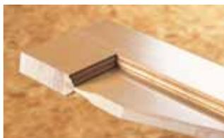
伝統的なアメリカンレイズドパネル。ジェルドウェンのインテリアドアのパネル部は従来のムク材からMDFの単板貼りにすることでパネルのずれ、割れを解消しました。
